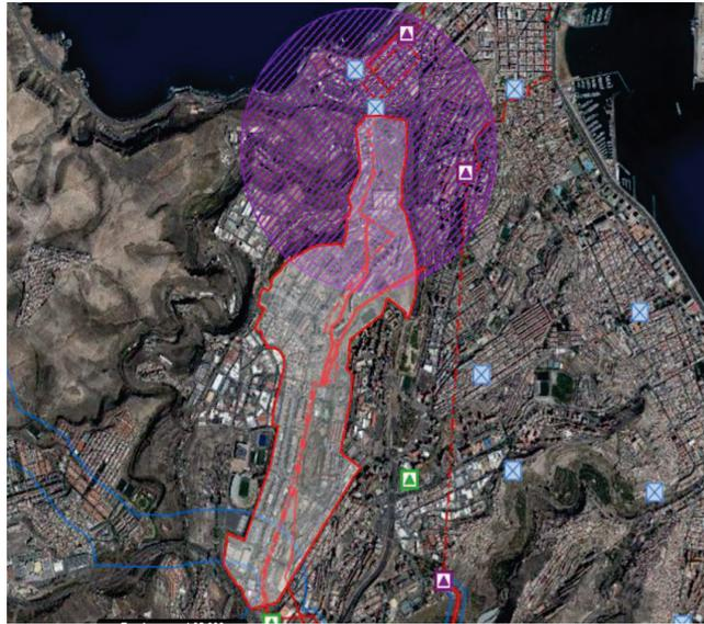
Ilustración 14: Estrategia Insular de Ordenación Energética: "Corredor de transporte de energía eléctrica" (trazado azul), trazado de MT (línea roja) y actuación REE-015 "Ámbito de apoyo infraestructural: Guanarteme-El Rincón".
