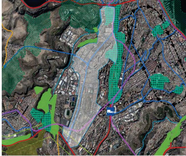
Ilustración 13: Instrucciones Territoriales Estructurantes PIOGC'22 superpuestas al ámbito de la MPGO. En morado acción estructurante RTT-002 (infraestructura ferroviaria). En trama verde ALU-001 Parque Urbano.
