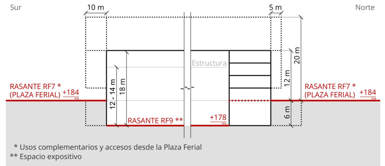
Esquema de la volumetría máxima del Pabellón 7, cuyos parámetros urbanísticos abarcan los 3 escenarios posibles (desmontaje total, parcial o conservación del edificio preexistente).
