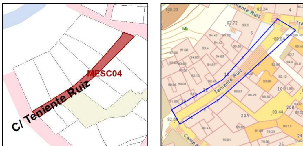
Se regularizará el trazado de las escaleras existentes en esta vía en donde una parte de éstas dan acceso a viviendas. Estos accesos puntuales escalonados deben respetar un ancho mínimo de circulación que garantice la accesibilidad.
