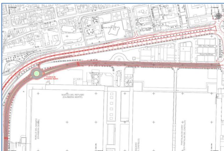
La ejecución de esta alternativa consiste en la eliminación de una glorieta y en la construcción de otra similar; más la construcción de una nueva conexión de la GC 1 con el viario interior del puerto. Por tanto es de mayor volumen de obras y con una afección algo mayor que la alternativa anterior. Unas afecciones poco significativas y concentradas en el periodo de ejecución de las obras.
