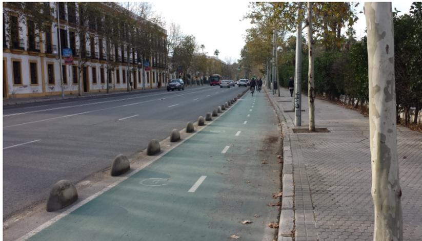
*Ejemplo de vía bidireccional con separador a nivel de calzada. Sevilla.*
