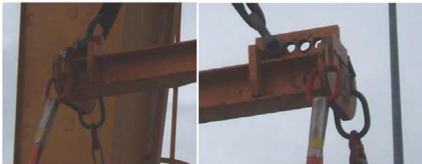
Figura 3.12: Detalle de ejemplos de eslingas con alargadores
