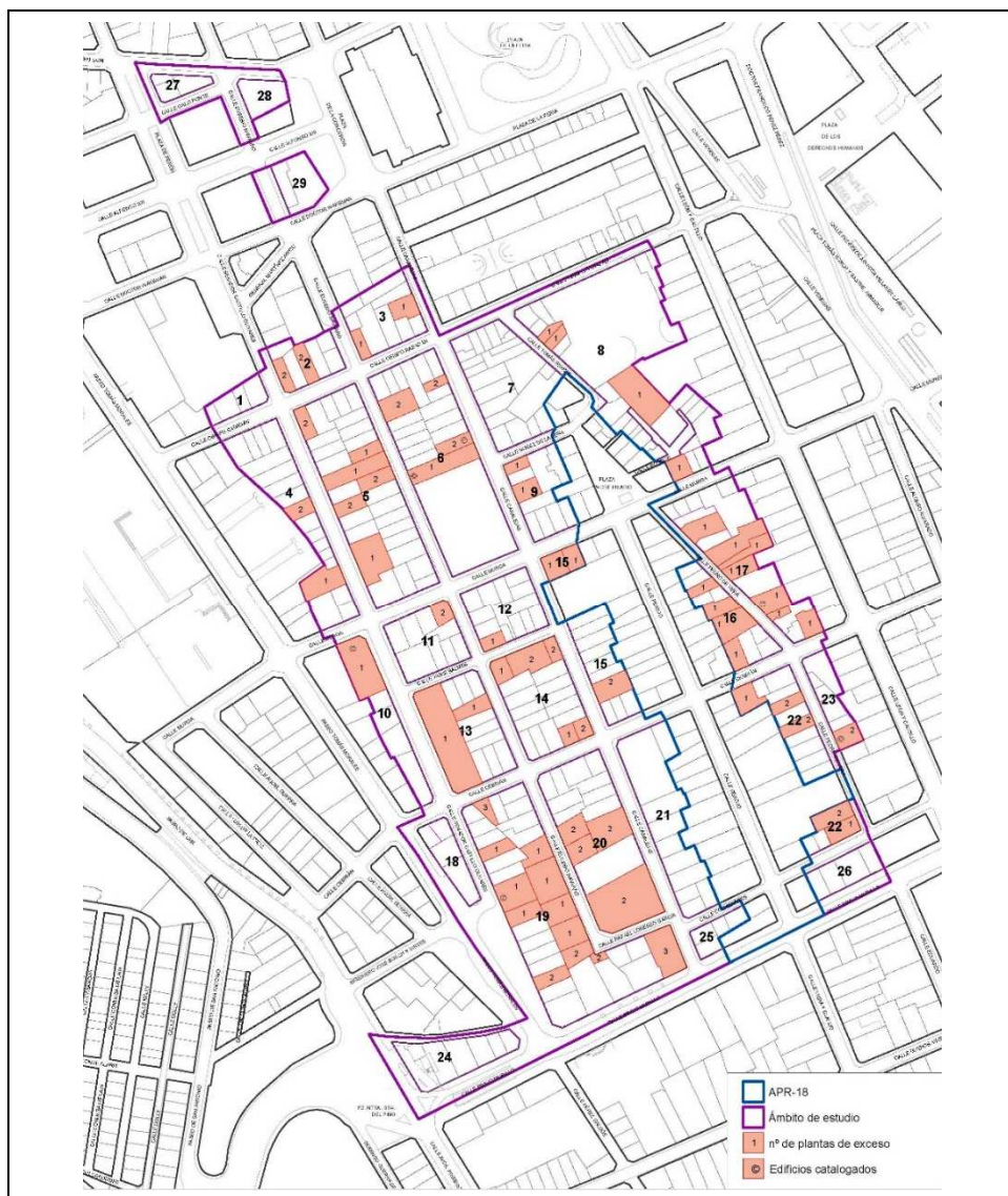
Figura 9. Parcelas que exceden la altura permitida con la aplicación de la nueva norma M y Mc.
